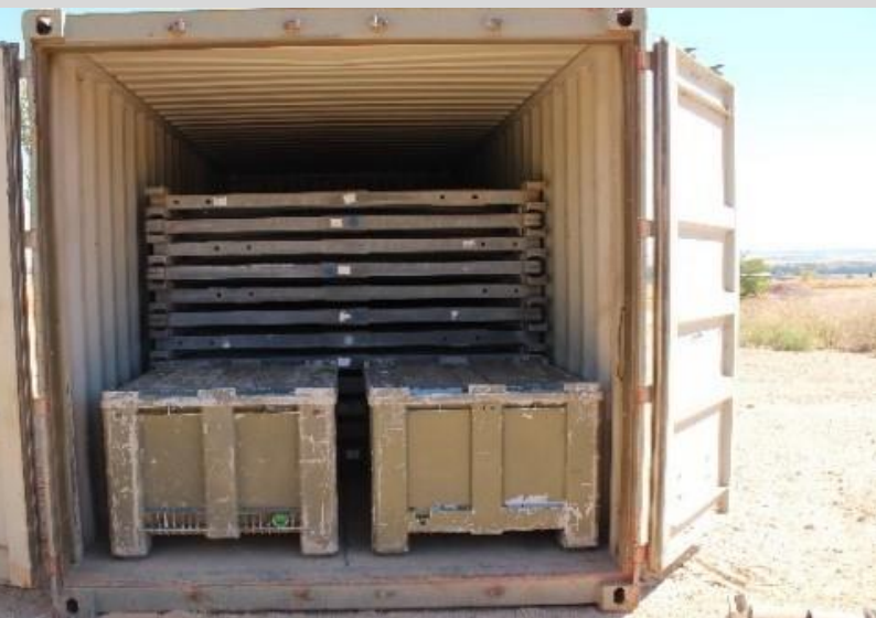
Detalle de dos bultos de paneles y dos CPR1 dentro de Contenedor ISO 20' de carga por un solo extremo
