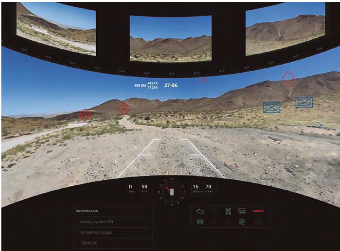
Puesto de conductor con sistema LSAS 360. Muestra la posición de las unidades con realidad virtual. La información mostrada al conductor es la necesaria para su función (Vegvisir)
