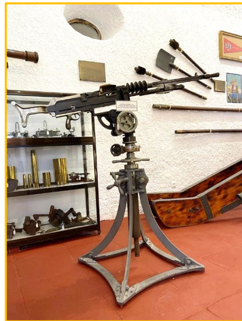
Ametralladora Hotchkiss M1914, actualmente expuesta esta seccionada para uso en la enseñanza.
