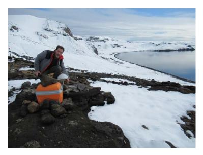
PROPOLAR: Monitorización de mediciones de la capa activa de Permafrost. Cambio de baterias de sensores. Cambio de escudo radioactivo.
