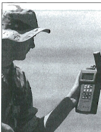
El aparato es fácil de manejar. Para captar la señal satélite dispone de una antena propia y puede colocarse otra en el casco.
