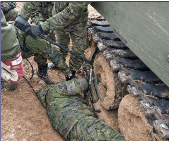
Ilustración 8. Trabajos de colocación de conectores en Letonia con palancas y medios improvisados. Fuente: archivo GACA X
