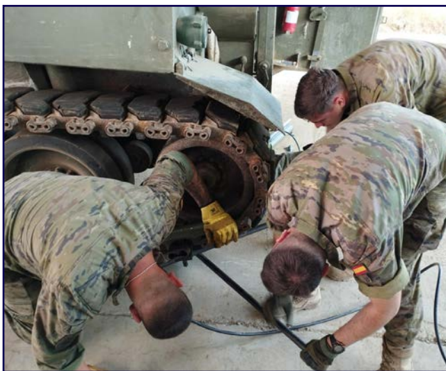
Ilustración 7. Colocación de conectores. Fuente: archivo GACA X
